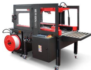
Kombi-Maschine Kartonverschliesser + Umreifer PackMaster Combipacker Ser.-Nr. FC0222680 / BM02502045 automatische Formateinstellung Rahmengrösse 850 x 600 mm 9mm Bandbreite
