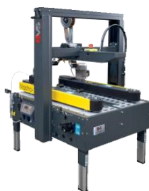
Kartonverschliesser Nastro SB M5 S Ser.-Nr. 5750002 Klebekopf K11 230 V
